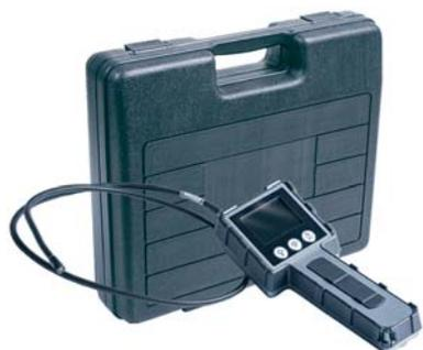
Videocamera portatile per ispezioni dei punti nascosti e difficilmente raggiungibili. Dotata di una sonda semirigida di 1 m con in testa una videocamera con 6 mini led. Le funzioni zoom e specchio rendono possibile una visuale aperta a 180° con restituzione dell'immagine su schermo ad alta luminosità di 2,36 pollici.
