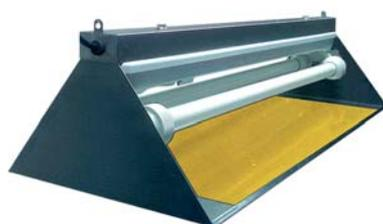
Trappola elettroluminosa in acciaio inox per insetti volanti. Può essere facilmente appesa al muro o al soffitto, posizionandola ad una altezza di circa 2-2,5 m. Dotata di cartone collante di colore nero e di 2 neon da 18 W cad. Possibilità di lampada shutter proof (optional).
