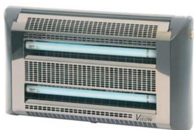
Trappola elettroluminosa in alluminio. Posizionamento a parete ad un'altezza di circa 2-2,5 m. Dotata di cartone collante di colore nero e 2 lampade UV da 15 W cad. La pratica apertura frontale consente di sostituire facilmente lampade e cartone collante.
